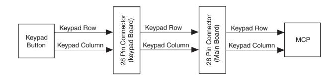
Figure 4-6. Keypad Block Diagram
