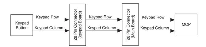
Figure 8-6. Keypad Block Diagram
