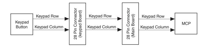
Figure 9-6. Keypad Block Diagram
