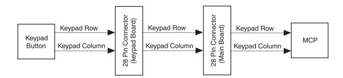
Figure 5-6. Keypad Block Diagram
